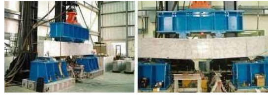
KKフォーム合成部材の静的載荷試験
