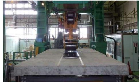
輪荷重走行試験による耐久性の確認
