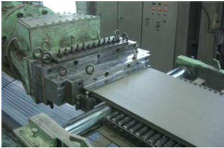
板の製造(真空押し出し成形)
